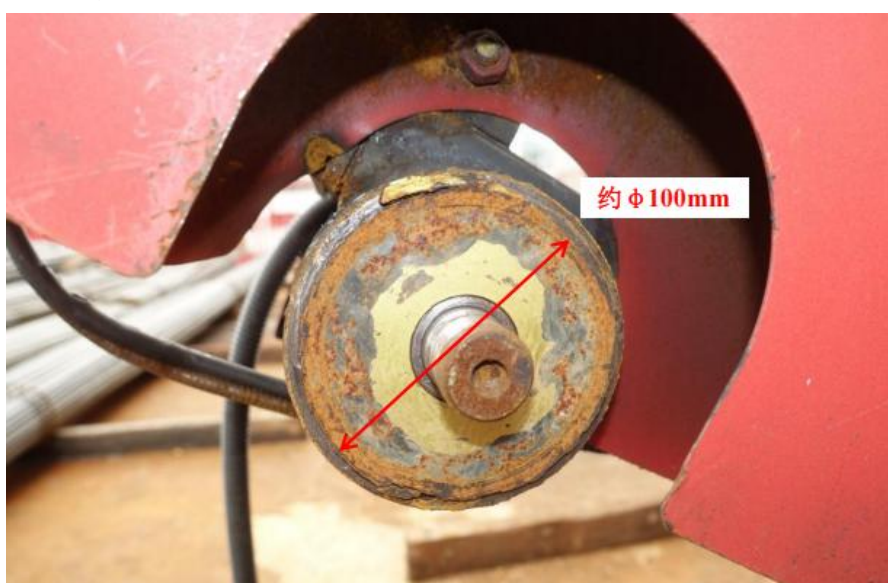
图 3 锈蚀的圆锯片中心部位
