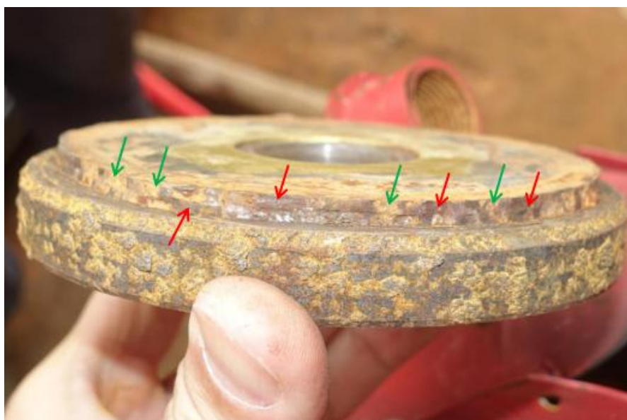
图 4 涉事圆锯片的碎片边缘
