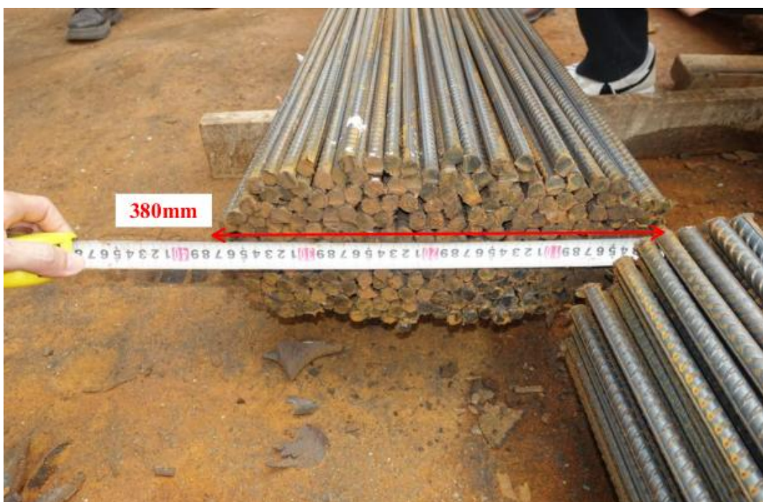
图 6 涉事整捆钢筋的切割面，各钢筋呈松散状态
