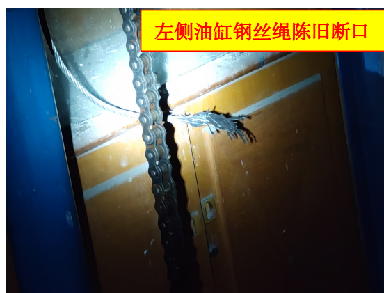
图 7 断裂的钢丝绳
