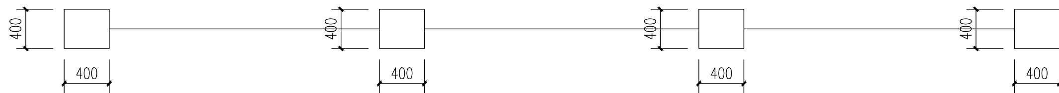
围栏基础平面图
