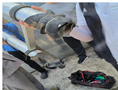
图 3 涉事伸缩梯绝缘套破损
