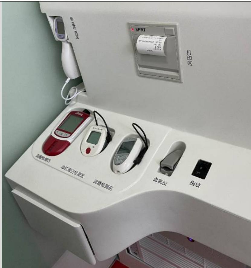
指纹录入, 血氧、体温、血糖、尿酸、总胆固醇等测量, 热敏打印区
